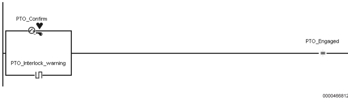
Figura 173 Lógica para la luz del tablero de medidores de PTO
