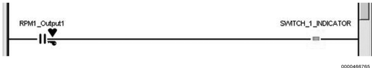
Figura 49 Controlar la luz indicadora para un interruptor momentáneo de 3 posiciones
