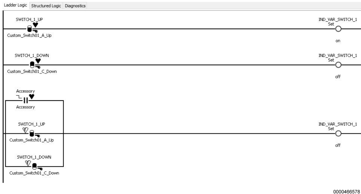
Figura 47 Desactivar la variable si se quita el accesorio o el interruptor está en mal estado
