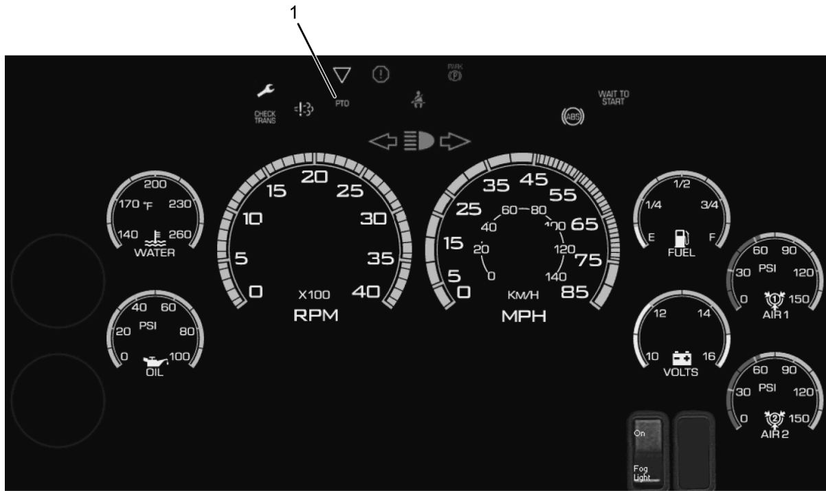
Figura 175 Vista del tablero de medidores con luz de PTO (vehículos fabricados en 2007 o después)
