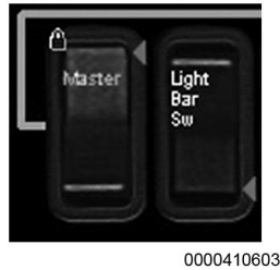
Figura 187 Interruptor en posición de encendido con bloqueo
