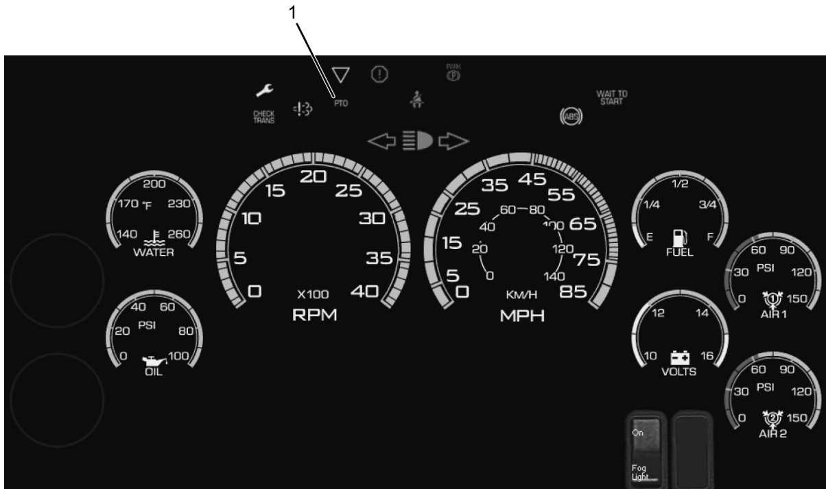
Figura 89 Funcionalidad de llave en apagado en el tablero de medidores (modelos posteriores al año 2007)
