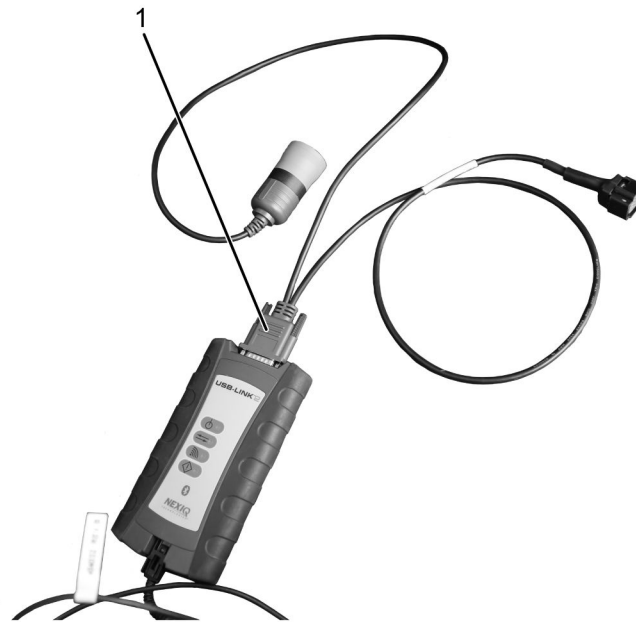
Figure 2. Pré-assemblage de câble adaptateur pour véhicule électrique 08-801-01
