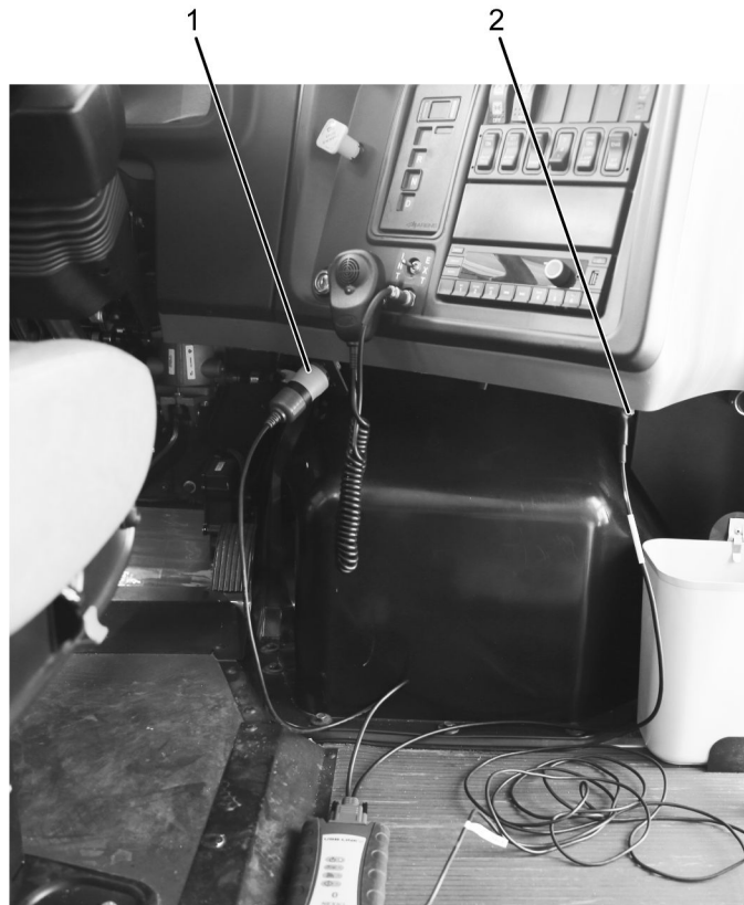
Figure 7. IC Bus® Électrique Série CE – 08-801-01 Connexion du câble adaptateur pour véhicule électrique
