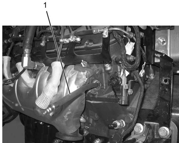
Figura 2. Acoplamiento de manguera de prueba de compresión OTC5606.
