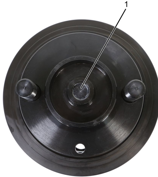
Figura 2. Parte inferior del instalador del sello del cigüeñal 12-183-09
