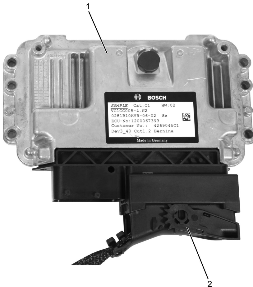
Figura 4. Cableado de programación 12-801-01-19 conectado al PIM
