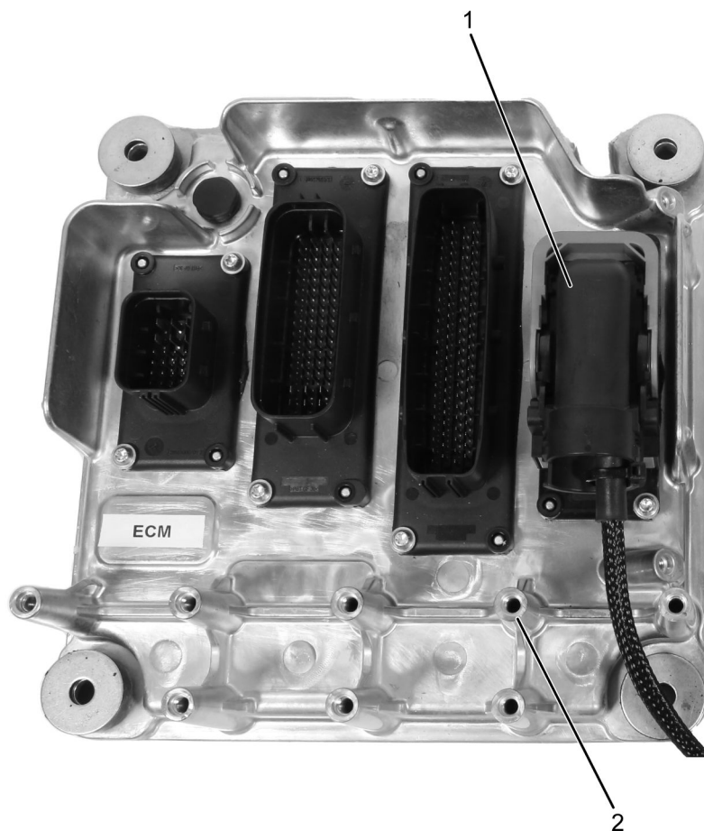
Figura 4. Módulo de control electrónico (Engine Control Module, ECM)
