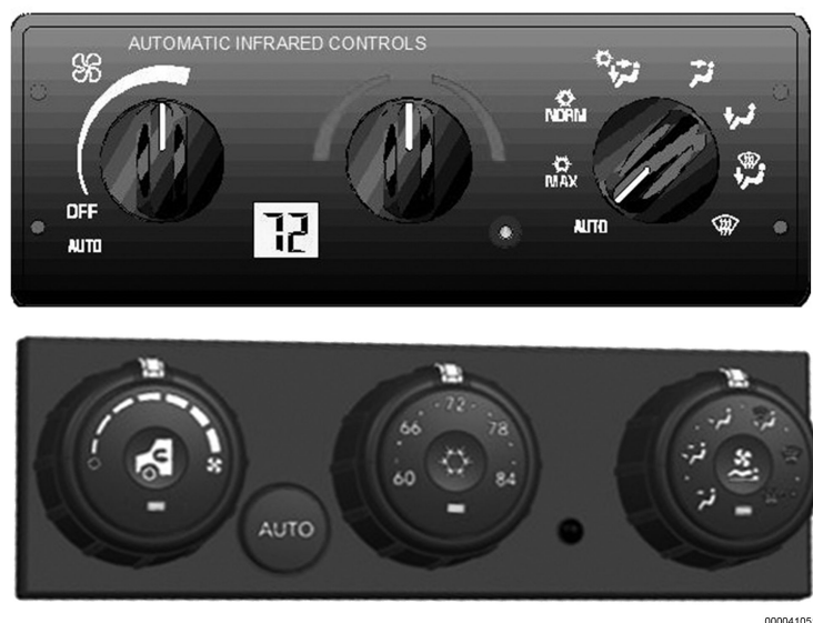
Figure 11 Deux exemples de panneaux de commande de la climatisation
