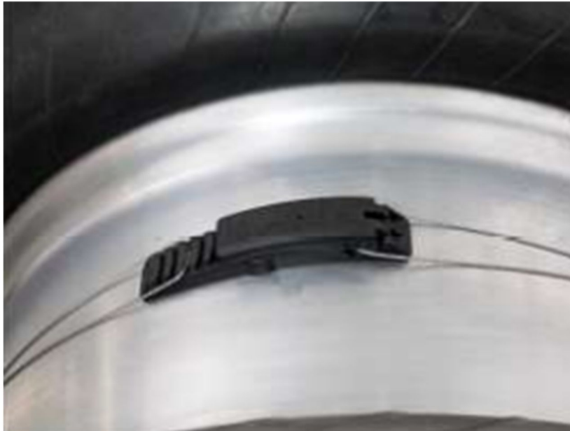
Figure 181 Capteur de roue installé
