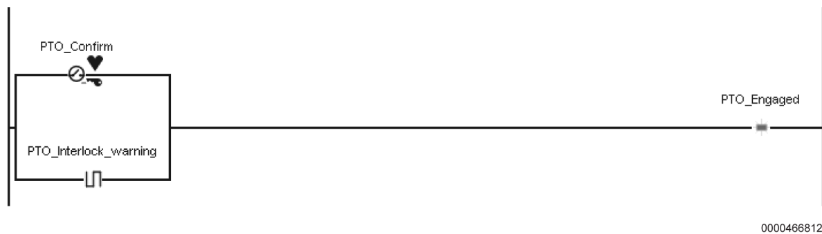
Figure 173 Logique de la lampe du bloc de jauge de PDF
