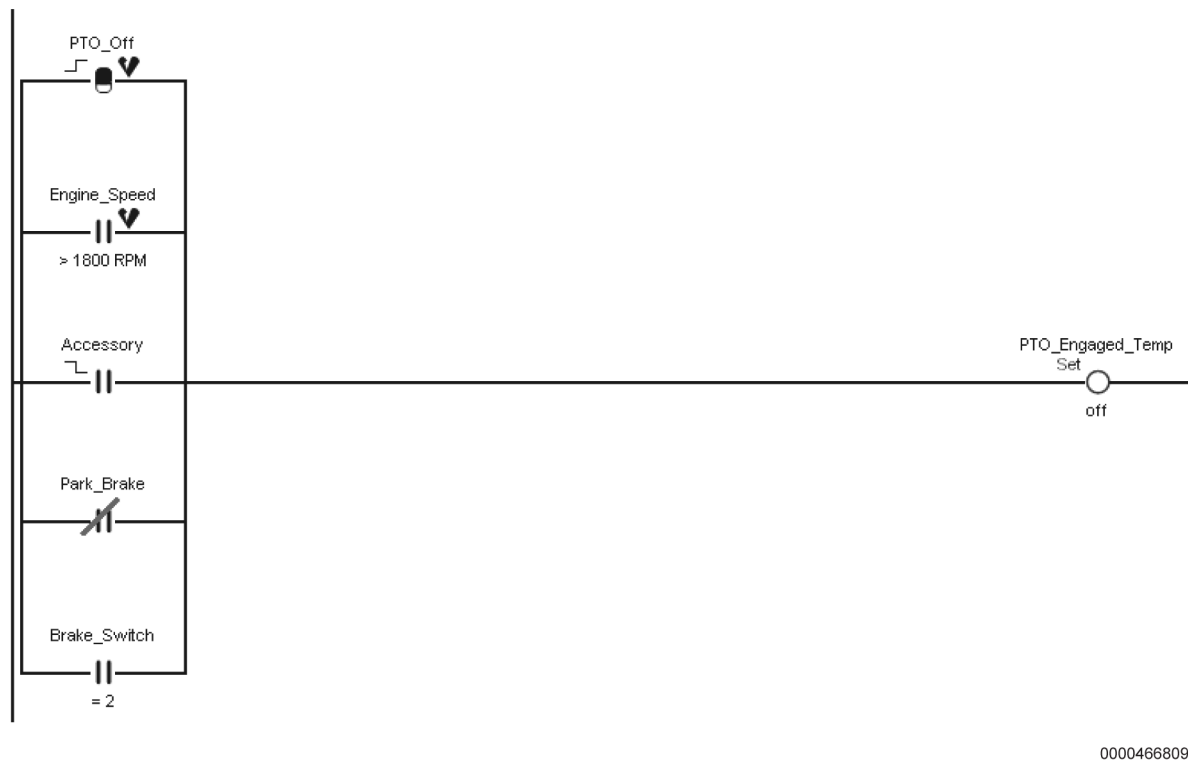
Figure 166 Réglez la variable sur OFF lorsqu'un ou plusieurs interverrouillages ne sont pas respectés
