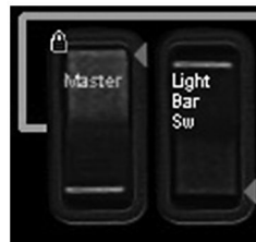
Figure 187 Interrupteur en position ON, avec verrouillage
