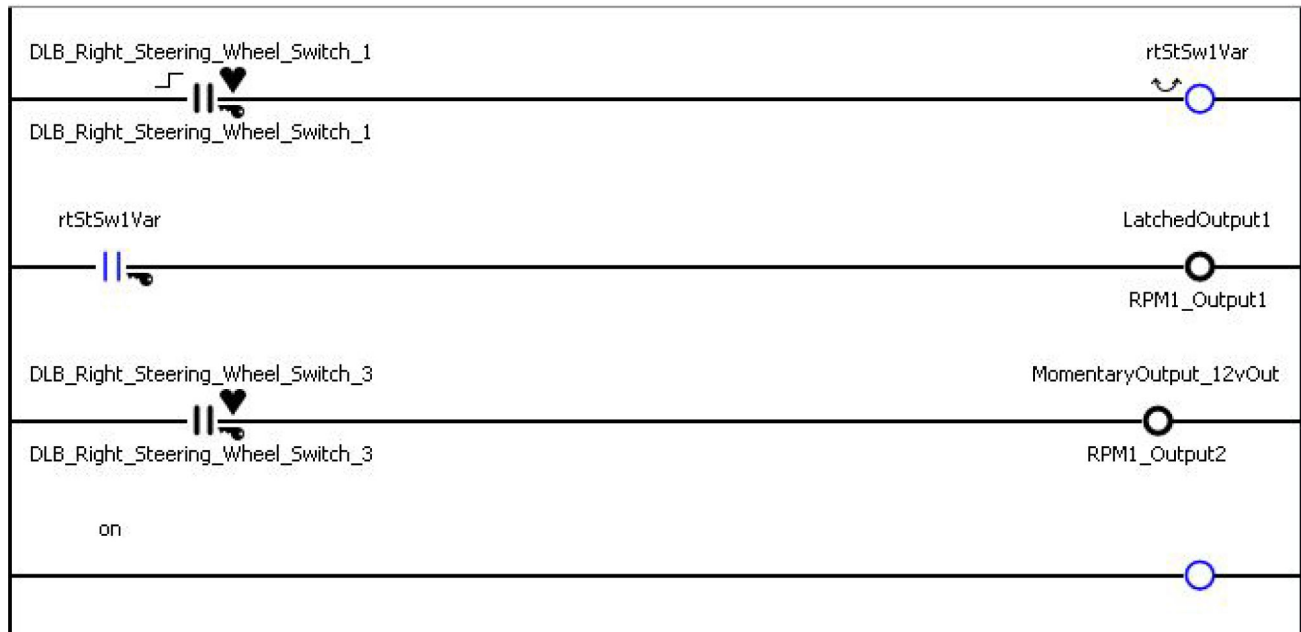
Figure 142 Exemple de logique Ladder avancé
