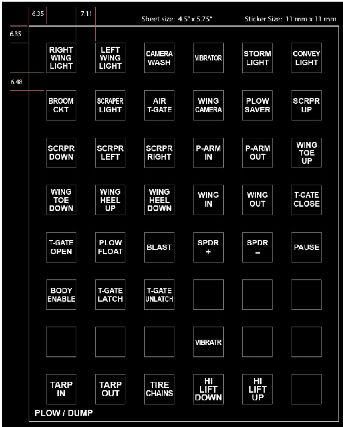
Figure 140 Feuille d'étiquettes d'interrupteurs au volant
