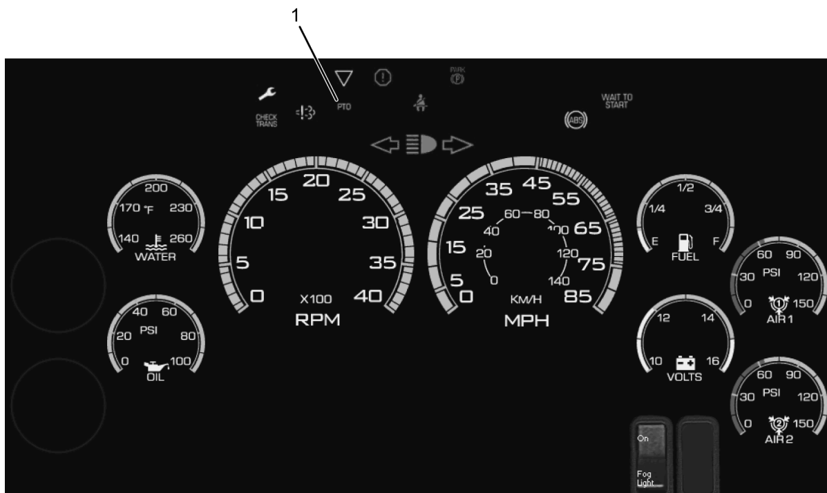
Figure 175 Vue du bloc de jauges avec le feu de la PDF (construit en 2007 ou plus tard)
