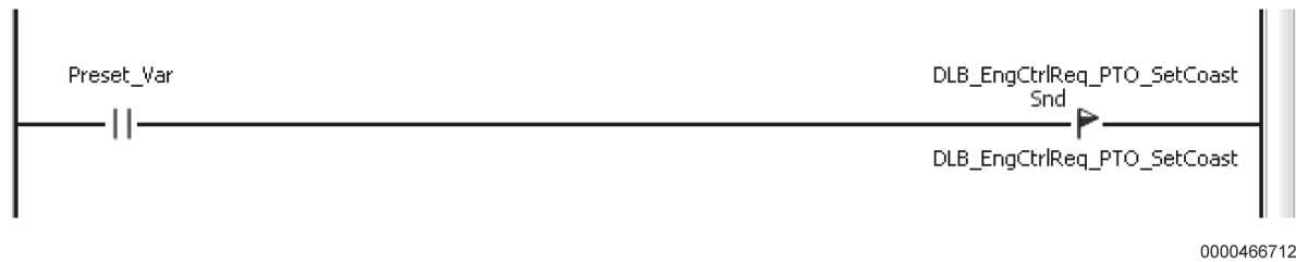
Figure 127 A26 Preset Engine Speed Control (Commande pré réglée de régime de moteur)
