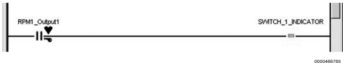
Figure 49 Commande de l'indicateur lumineux pour l'interrupteur momentané à 3 positions
