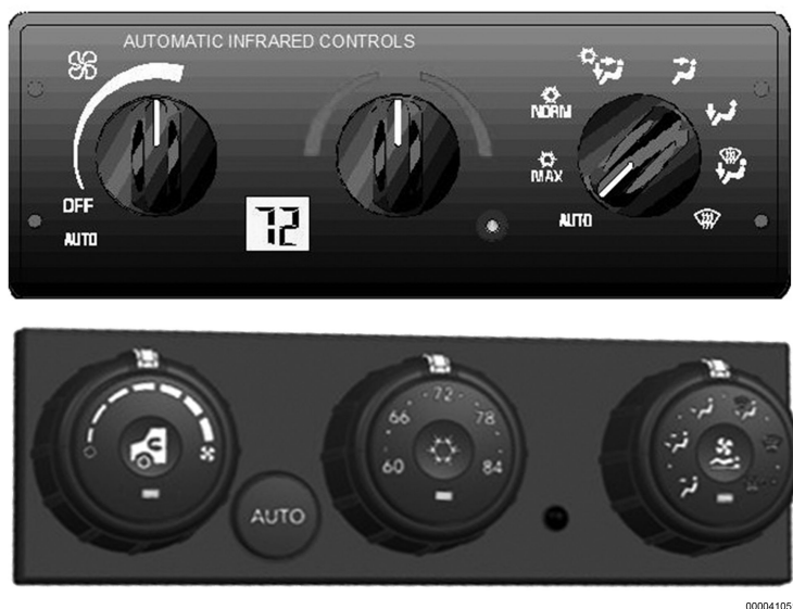
Figura 11 Dos ejemplos de paneles de control del sistema de calefacción, ventilación y aire acondicionado (HVAC)
