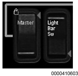
Figura 226 Interruptor en posición de encendido con bloqueo
